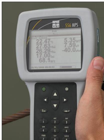
Figura 15 – Aparelho multiparâmetro YSI 556 MPS
